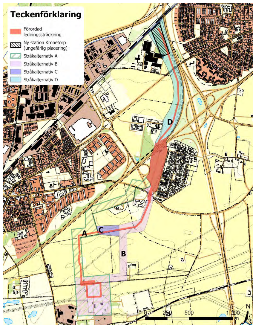
Figur 3. Förordad ledningssträckning (röd markering) för ny 2x130 markkabel mellan Sege och Kronetorp.
