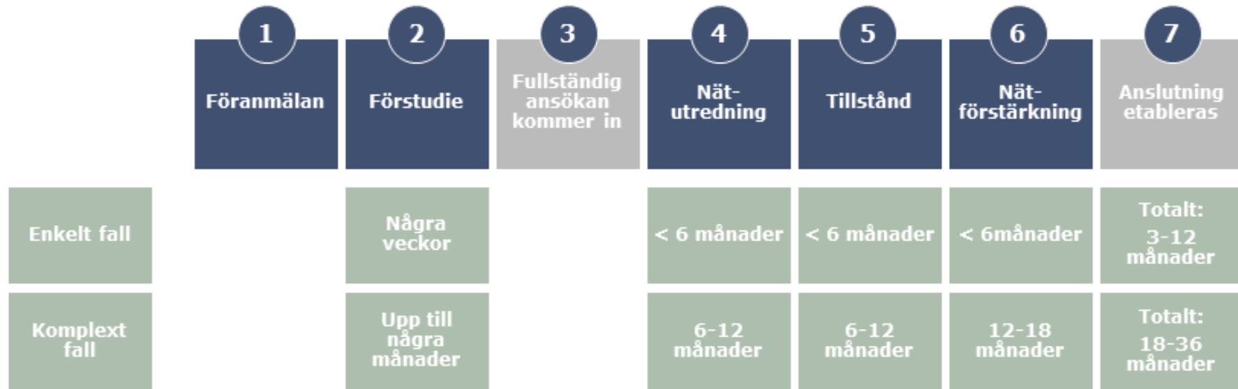
Figur 5: Ungefärliga ledtider för att ansluta 100–200 kW med varierande komplexitet.
