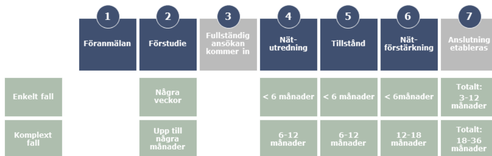
Figur 5: Ungefärliga ledtider för att anslutning till elnätet med varierande komplexitet. En större version av figuren återfinns i bilagor.
