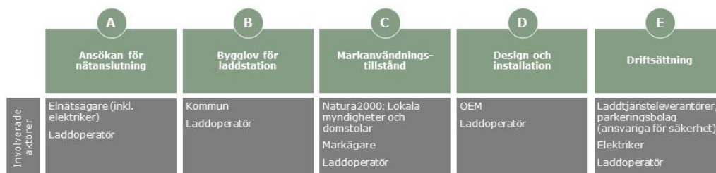
Figur 3: Etableringsprocessen för publik laddinfrastruktur. Processen är inte helt sekventiell då bygglov (aktivitet B) och markanvändningstillstånd (aktivitet C) kan sökas parallellt, och design (del av aktivitet D) kan påbörjas när nätanslutningen har utretts av elnätsägaren. Därefter sker installation (del av aktivitet D) följt av driftsättning (aktivitet E). En större version av figuren återfinns i bilagor.
