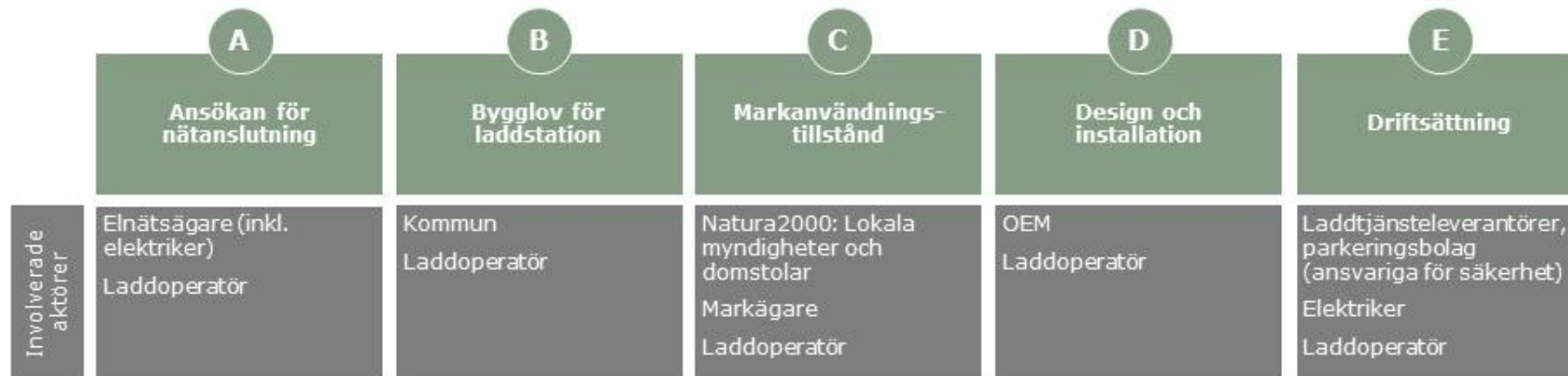
Figur 3: Etableringsprocessen för publik laddinfrastruktur. Processen är inte helt sekventiell då bygglov (aktivitet B) och markanvändningstillstånd (aktivitet C) kan sökas parallellt, och design (del av aktivitet D) kan påbörjas när nätanslutningen har utretts av elnätsägaren. Därefter sker installation (del av aktivitet D) följt av driftsättning (aktivitet E).
