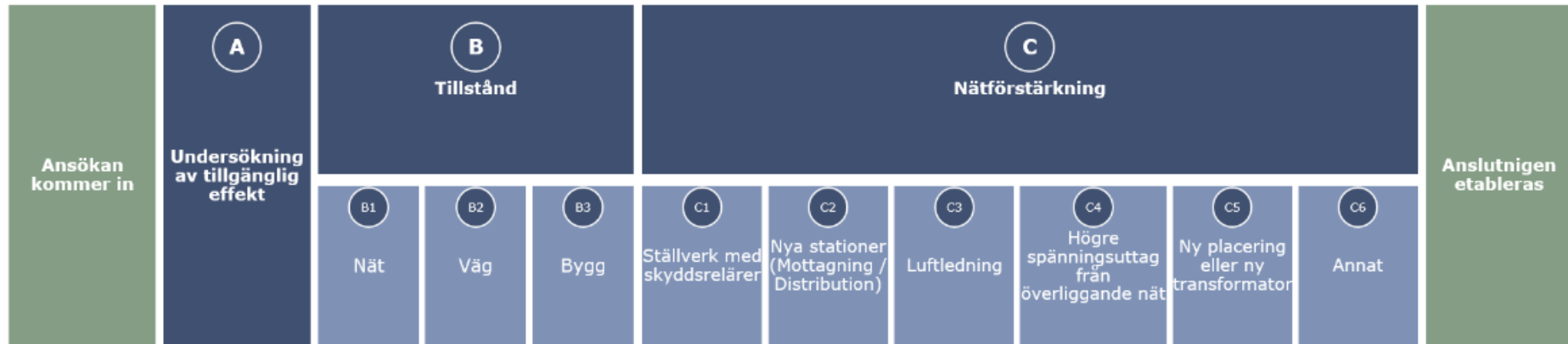
Figur 1: Vägledande bild över en elnätsägares process från dess att en ansökan inkommit till dess att en anslutning har etablerats.
