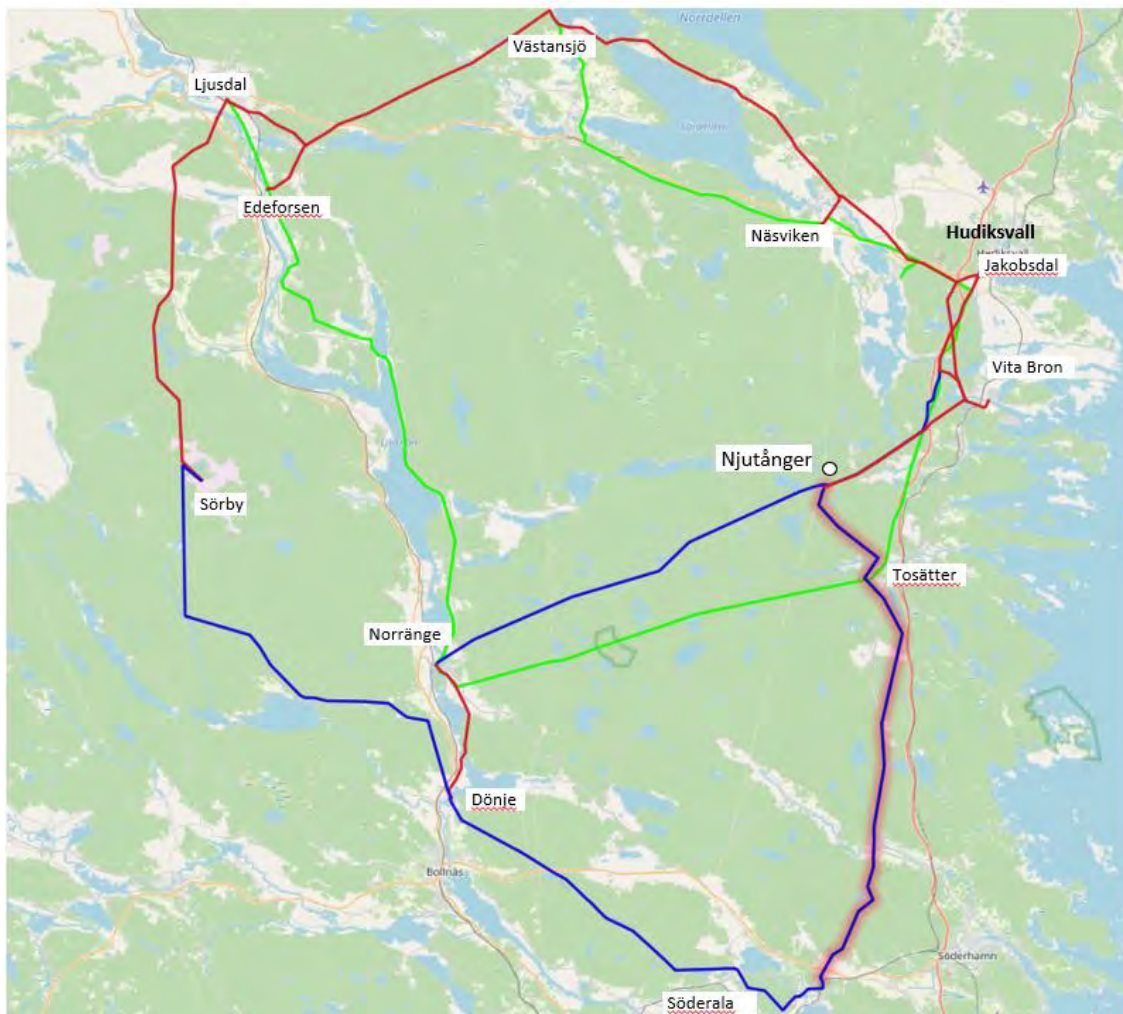
Figur 3. Målbilden år 2032 för regionnätet i östra Hälsingland efter planerade åtgärder med nya stationer och ledningar. Ett robust nät med två ringstrukturer har skapats. Blå linjer är nya eller ombyggda 130 kV ledningar och de gröna linjerna är Ellevios 40 kV ledningar. Regionnätet ansluter till stamnätet vid station Njutånger. Aktuell ledning mellan Njutånger och Söderala är markerad.
