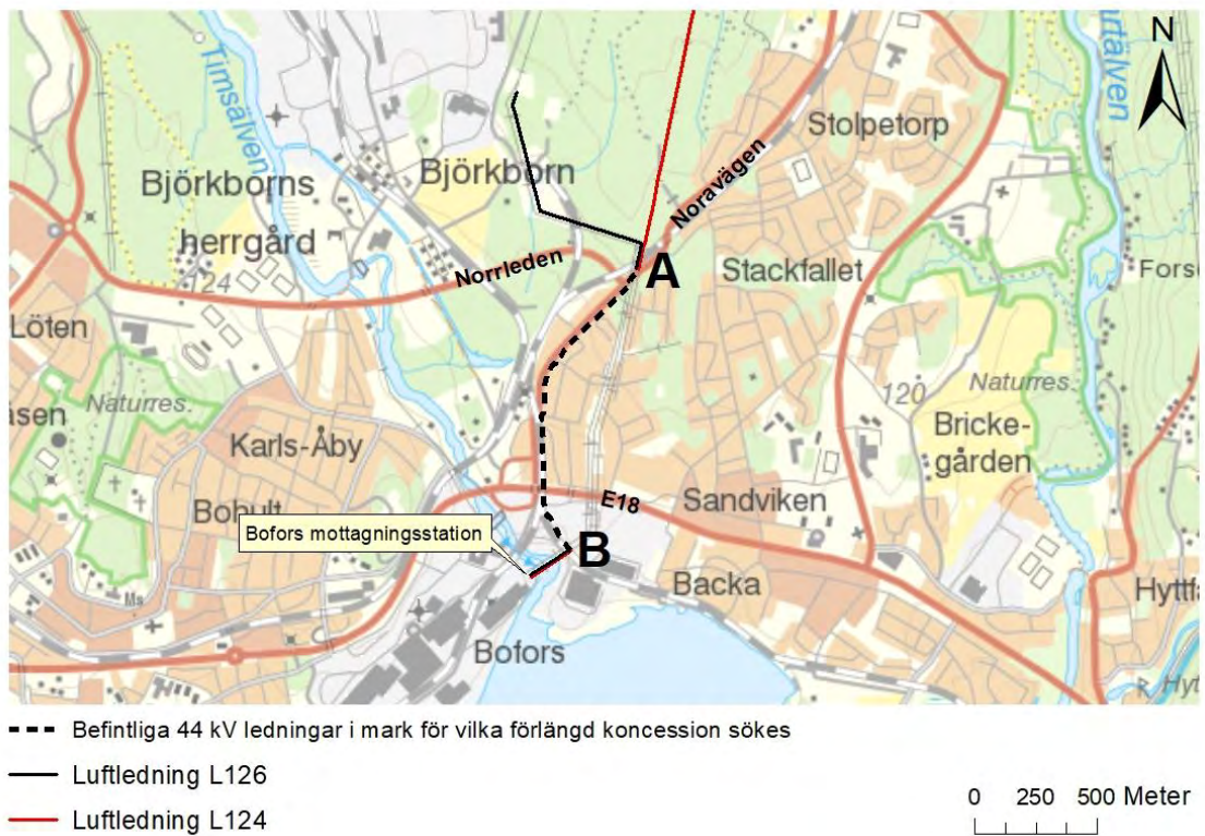
Figur 2. Befintliga markkablers sträckning (streckad linje). De heldragna linjerna visar delar av ledningarna som är uppförda som luftledning.
