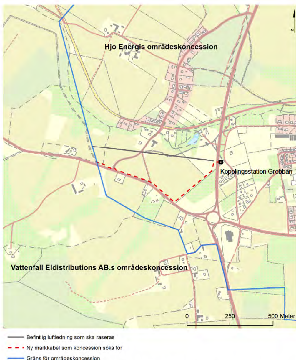
Figur 3. Planerad markkabel (röd streckad linje) och den befintliga luftledningen (grå heldragen linje) samt gränsen för områdeskoncession (blå heldragen linje).
