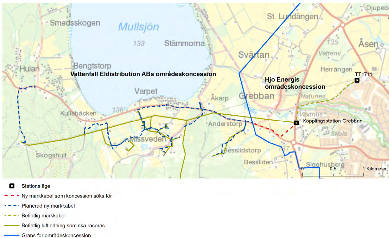
Figur 1. Befintlig luftlednings och markkabels lokalisering och lokalisering av ny markkabel i samband med ombyggnationen av lokalnätet i området. Luftledningen är markerad i gult och ny markkabel för vilken koncession söks i rött. Den blå streckade linjen visar övrig ny markkabel som är planerad i området, inom Vattenfall Eldistributions områdeskoncession. Den gula streckade linjen visar befintlig markkabel för vilken förnyad koncession för linje söktes våren 2018. Den blå heldragna linjen markerar gränsen för områdeskoncession.
