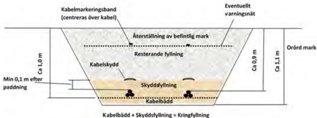
Figur 2. Principskiss på genomskärning av kabelgrav
