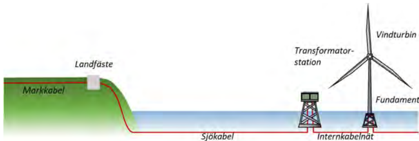
Figur 1. Schematisk bild över en havsbaserad vindkraftpark med tillhörande delar. Denna tekniska beskrivning omfattar sjökabel (nedgrävd exportkabel), landfäste samt markkabel fram till anslutningspunkten till det nationella transmissionsnätet.
