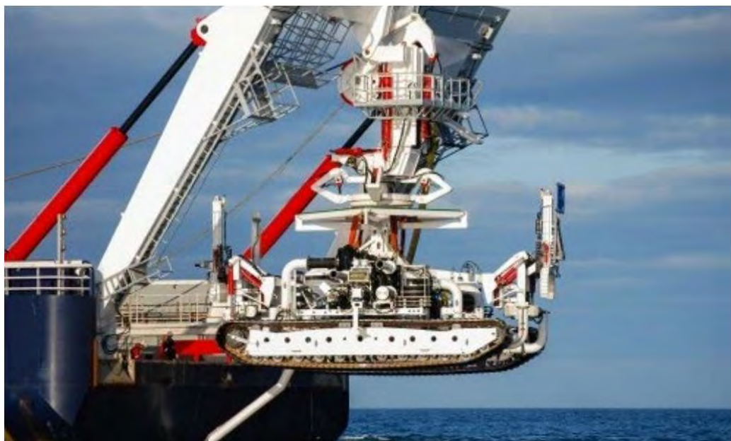
Figur 11. Exempel av fjärrstyrd farkost – mekaniskt skärverktyg
