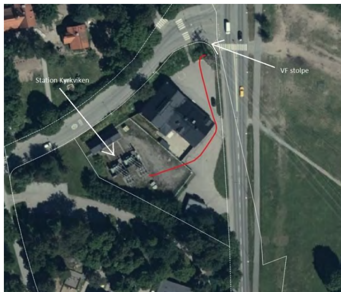
Figur 2. Station Kyrkviken, markkabelförbandens läge i mark framgår av den röda linjen. I bilden kan även skuggan av Vattenfall Eldistributions stolpe och faslinor skönjas.
