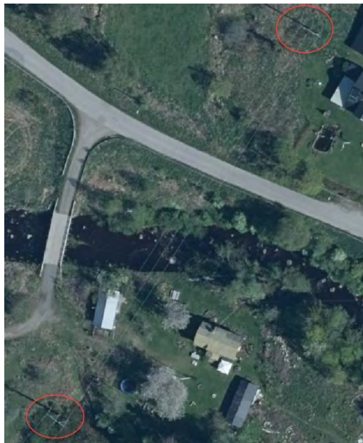
Figur 1. Befintlig stolpplacering 40-60m vardera sida ån. Bro i väst som kan utnyttjas vid arbetet.
