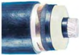
Figur 5. Enfasledare för markförläggning. Innerst en ledare av aluminium. Utanför ledaren isolation av PEX samt ytterst ett skyddshölje av polyeten. Bildkälla: ABB.
