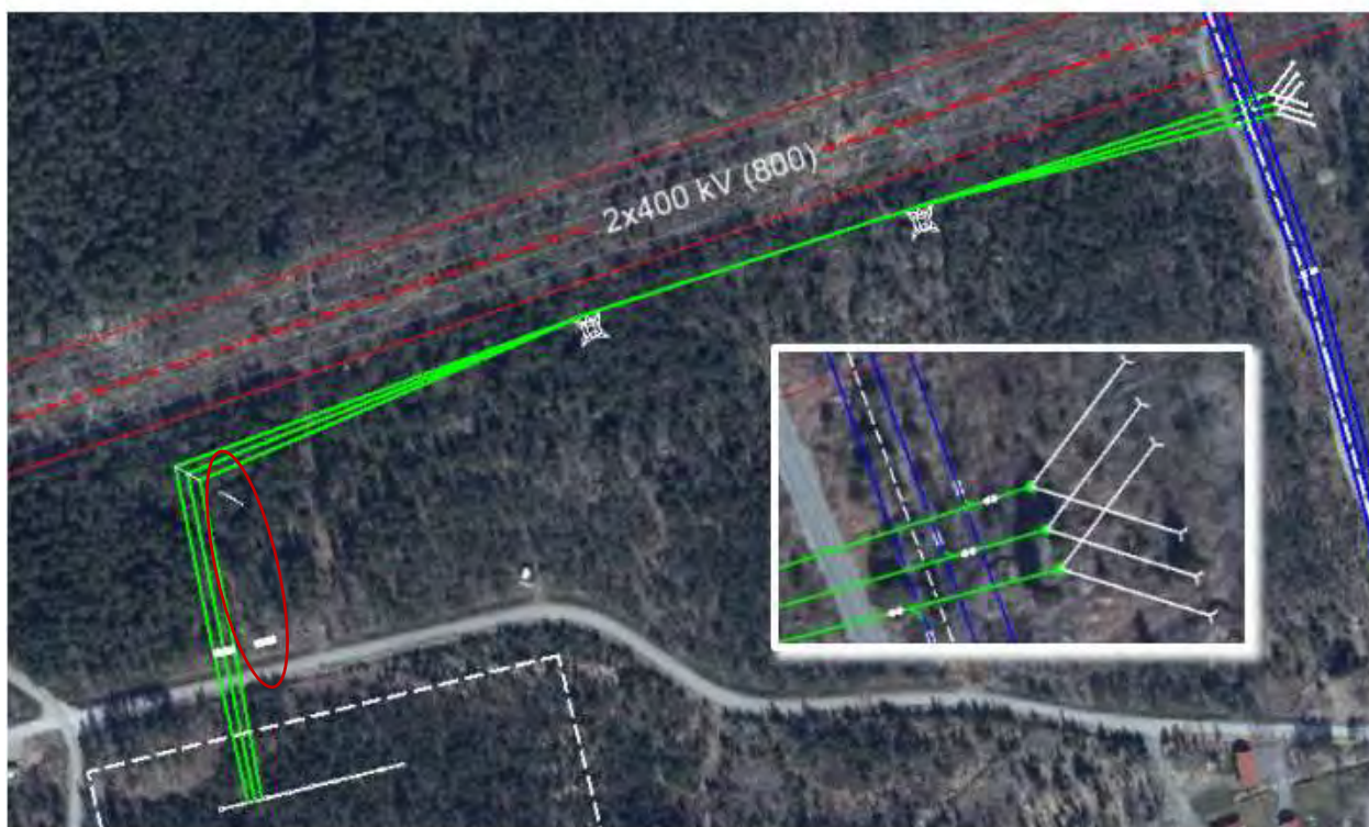
Figur 2. Planerad sträckning för avgreningen till Odensala Östra med en tillfällig påkoppling (säng) på ÄL9 S2. Bilden visar även planerade stolpar för kommande 130 kV-ledning (röd oval) och sambyggnadsstolparna. Stolplaceringarna är preliminära och kan komma att ändras vid senare detaljprojektering.
