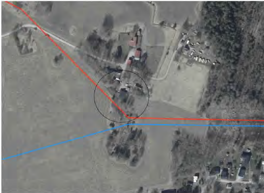
Figur 1. Magnetsfältberäkning Beräkningspunkt 3 vid ÄL395 Sala-Stampers (röd linje), se figur i full storlek i bilaga III.
