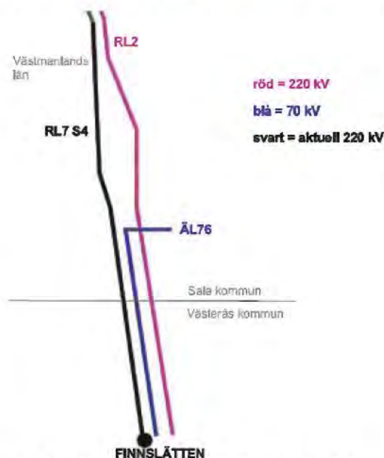
Figur 2.3. Schematisk skiss över 220 kV ledningen RL7 S2-4 sträckning genom Västmanlands län i förhållande till andra kraftledningar.
