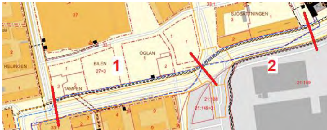
Figur 3. Studerad sträckning där 130 kV löper parallellt med 4 st 10 kV-kablar. Vid avgränsningen mellan delsträcka 1 och 2 byter M39 och M40 plats. 130 kV-ledningarna är markerade med blå streckad linje i figuren. Lokalnätskablarna är markerade med svarta streckade linjer och löper längs med den övre sidan av vägen i figuren.
