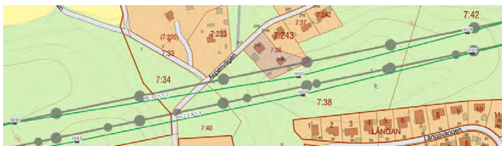
Figur 2. Figuren visar de spann som behöver åtgärdas för att åstadkomma en tydlig magnetfältreduktion för fastigheten Tumba 7:36.
