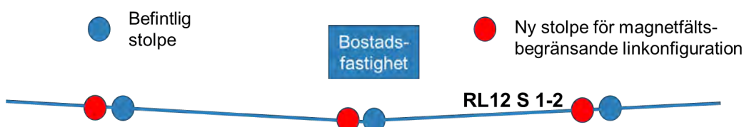
Figur 3. Figuren visar hur en teknisk åtgärd schematiskt skulle kunna se ut. Denna lösning kräver att tre stolpar rivs (blå cirklar) och tre nya stolpar etableras (röda cirklar) i de gamla stolparnas närområde. Stor del av etableringen behöver göras under driftsatt ledning för att minimera avbrotts tiden. Vid inkoppling är dock avbrott i åtminstone några dygn i det närmaste oundvikligt.
